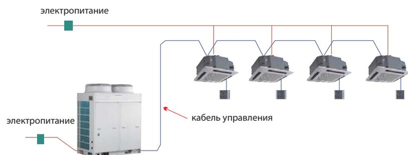
Двухпроводная система передачи электроэнергии позволяет подключать несколько внутренних блоков к одному наружному модулю при помощи двухжильного провода, что значительно облегчает монтаж проводки.
