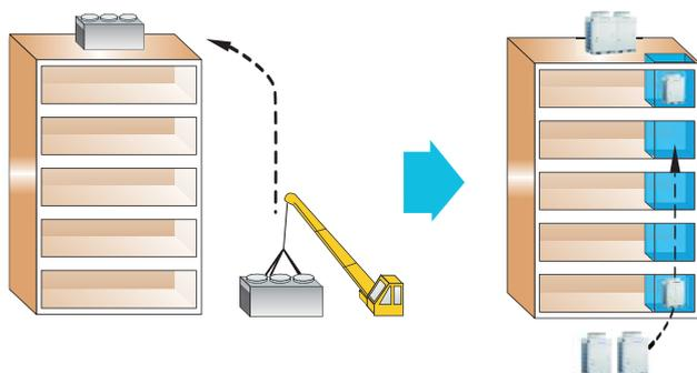
Компактный размер внешнего блока (его ширина составляет всего лишь 770мм) позволяет обойтись без специальных кранов и воспользоваться обычным лифтом для его подъема на крышу здания. Благодаря упрощенной системе прокладки труб, блок можно установить за короткое время, а также значительно уменьшить стоимость монтажа.
