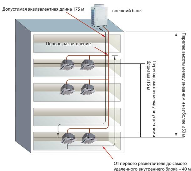
Система DV-MAX i позволяет варьировать размещение блоков и отлично подходит для кондиционирования высотных зданий. Расстояние между внешним и наиболее удаленным внутренним блоком может достигать 175 м, а перепад высоты – 50 м. Перепад высоты между внутренними блоками может составлять 15 м, что является самым высоким показателем в современной промышленности.
